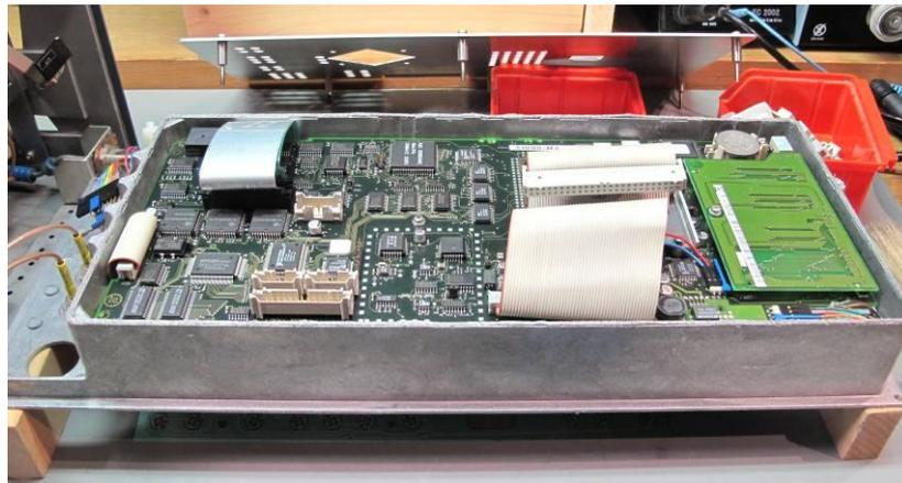
**Abbildung 6: Displaymodul ohne Rückwand**
