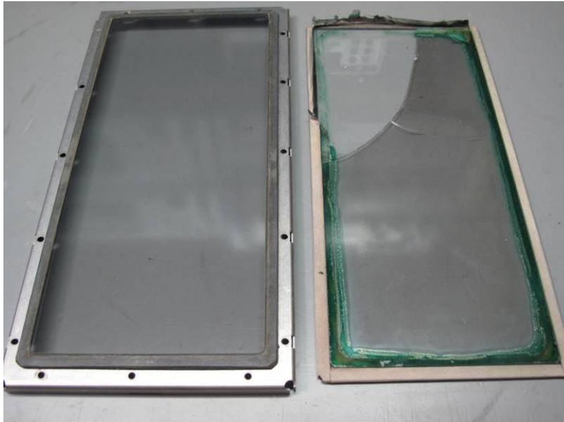
**Abbildung 11: Vorgucker: links ein heiles und rechts das defekte Displayglas**
