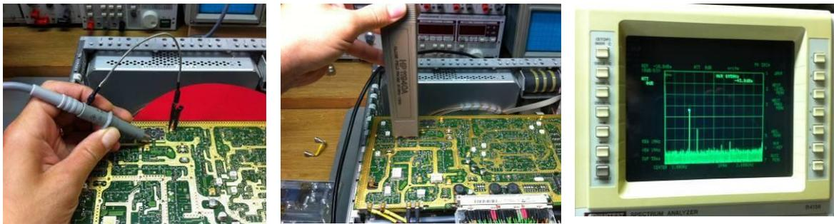
Abbildung 26: Quick-Check mit HF-Tastkopf, HF-Feldsonde und Spektrumanalyser
